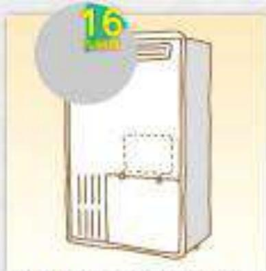
電気温水器からCO<sub>2</sub>冷媒ヒートポンプ給湯器に更新。
