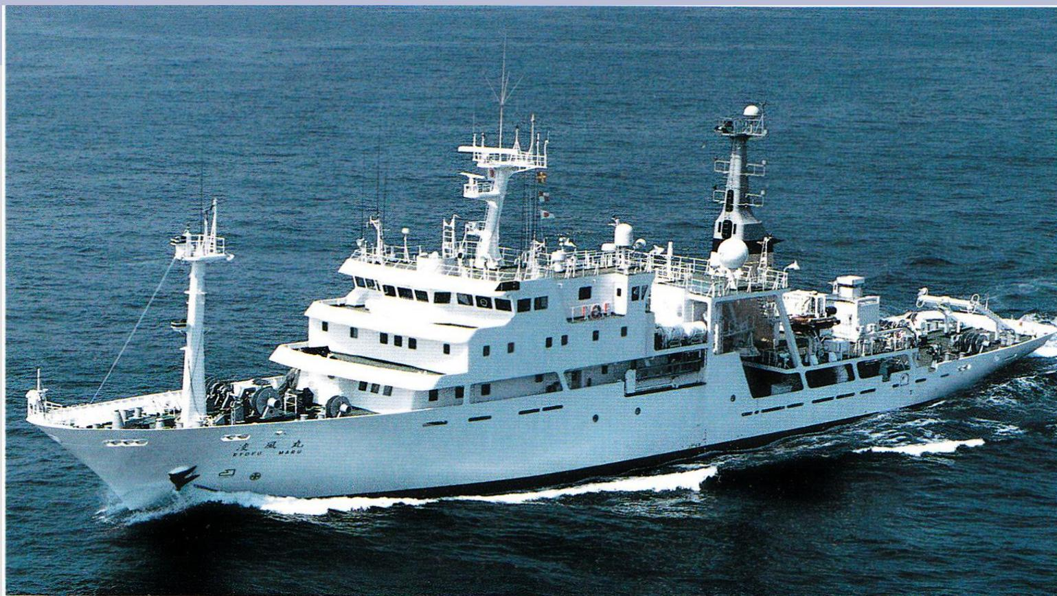
凌風丸Ⅲ 1380トン 全長82m 全幅13m 14ノット 1995年建造
