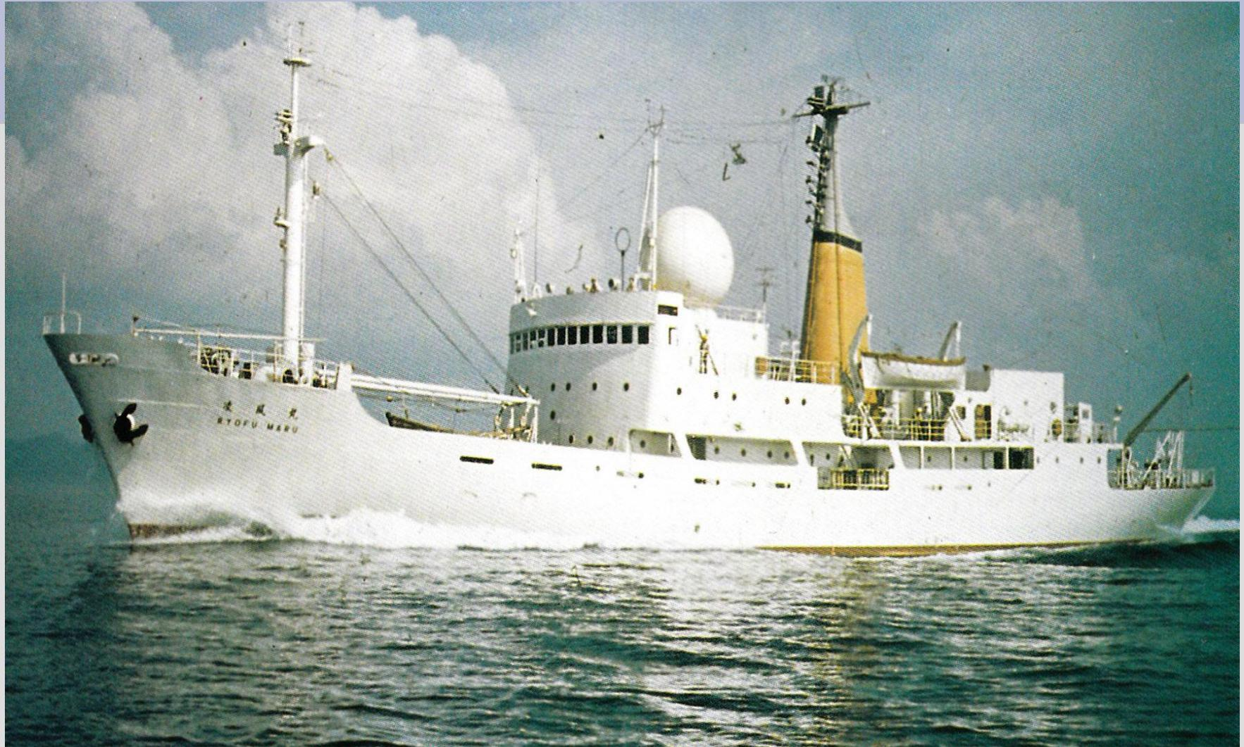
凌風丸Ⅱ 1500トン 全長79.2m 全幅12.0m 速力13ノット 1966年建造
