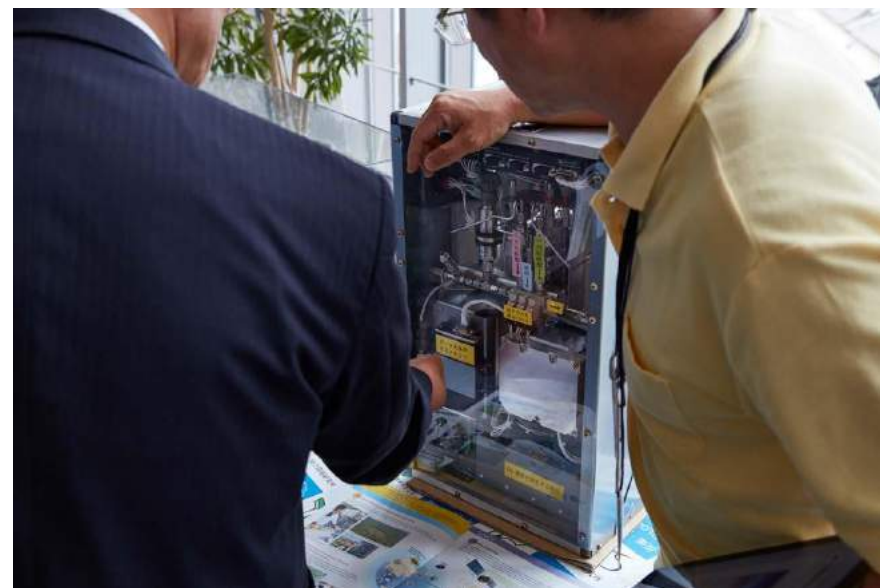
航空機に搭載している二酸化炭素濃度連続測定装置
